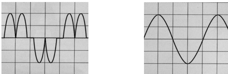
Obr. 1 Srovnání deformace síťového proudu u 6-ti pulsní tyristorové (vlevo) a AFE tranzistorové (vpravo) jednotky
